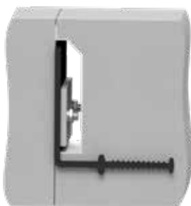
Typ KFB – invändigt klämfogband för arbetsfogar/rörelsefogar
