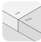
Junta de construcción
