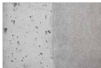
sin Zemdrain® (izquierda) contra con Zemdrain® (derecha)
