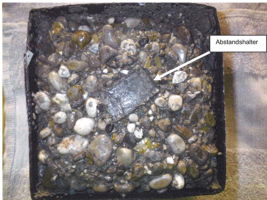
Bild 4: Probe 1 nach 28 Frost-Tau-Wechsel sehr stark abgewitterte Betonoberfläche. Am Abstandshalter keine Ablösungen erkennbar.
