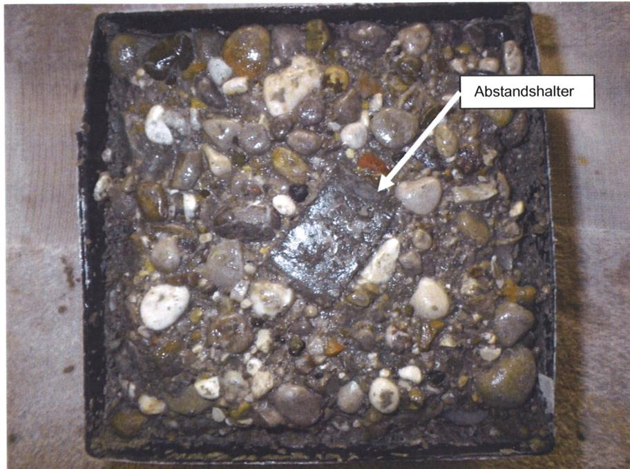
Bild 5: Probe 2 nach 28 Frost-Tau-Wechsel sehr stark abgewitterte Betonoberfläche. Am Abstandshalter kleine Ablösungen erkennbar
