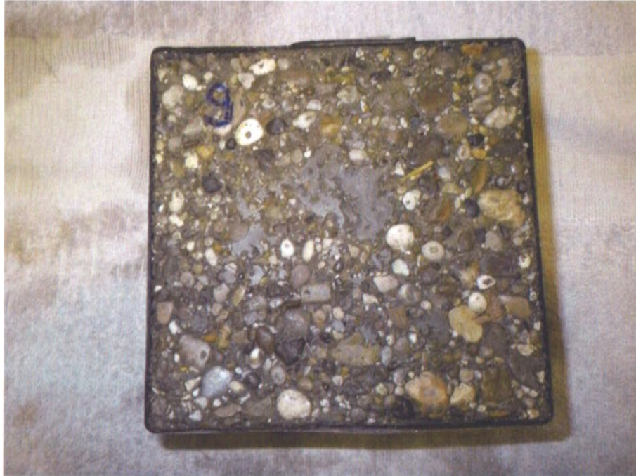
Bild 8: Probe 9 nach 28 Frost-Tau-Wechsel, abgewitterte Oberfläche. kleine Ablösungen am Abstandshalter erkennbar.
