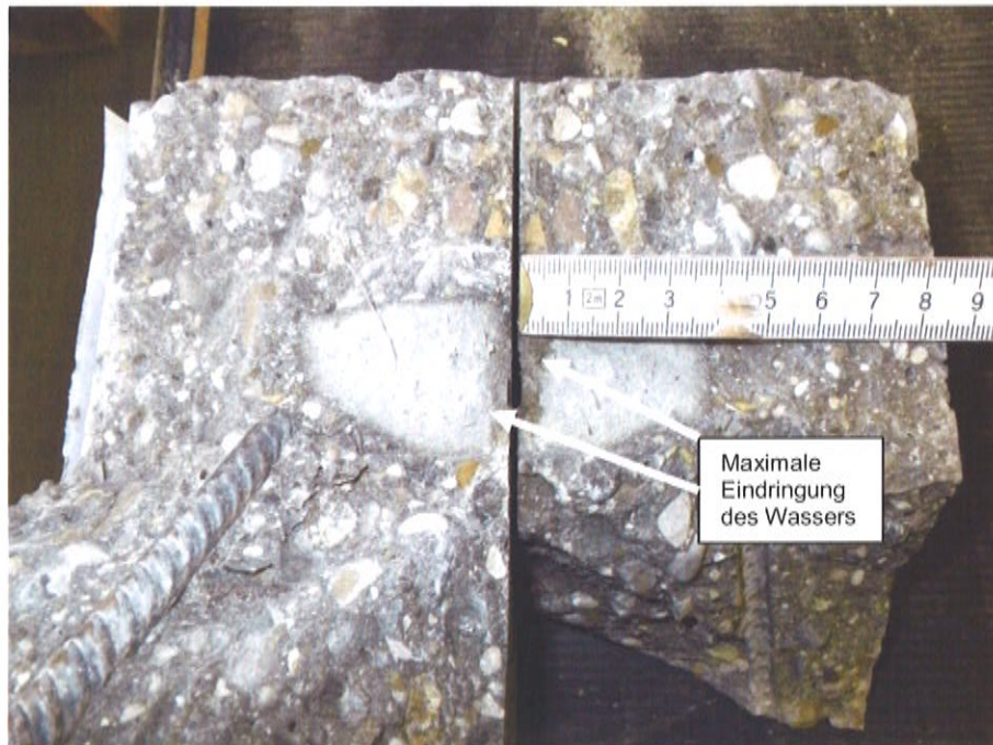
Bild 3: Probe 1 nach dem Aufspalten zur Messung der Wassereindringtiefe 7 mm
