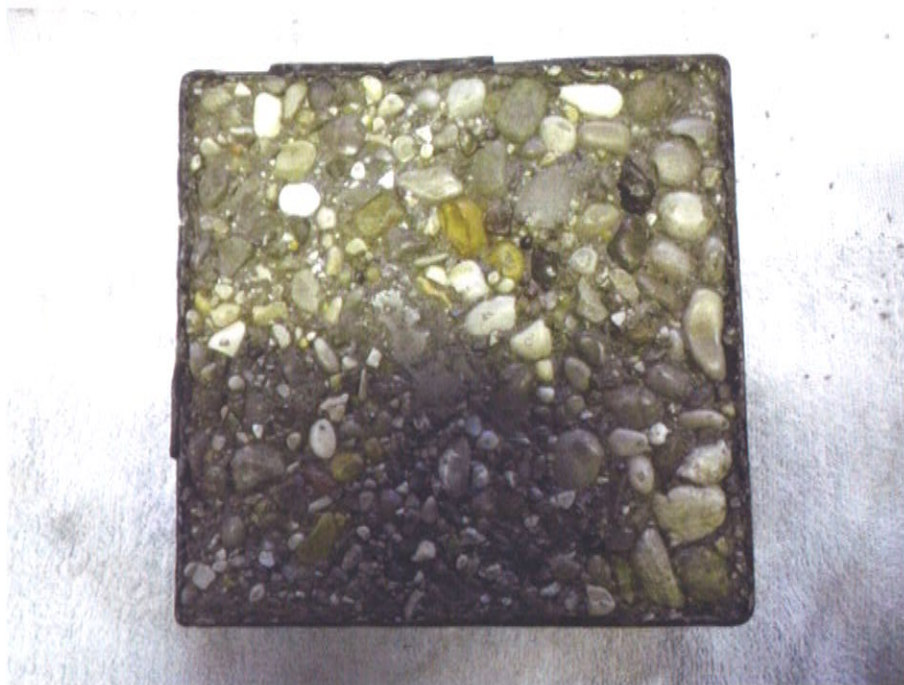
Bild 6: Probe 7 nach 28 Frost-Tau-Wechsel, abgewitterte Oberfläche. kleine Ablösungen am Abstandshalter erkennbar.
