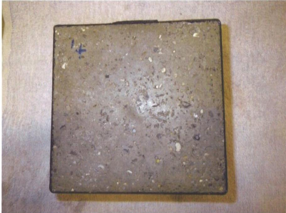
Bild 6: Probe 4 nach 28 Frost-Tau-Wechsel, abgewitterte Oberfläche. keine Ablösungen am Abstandshalter erkennbar.
