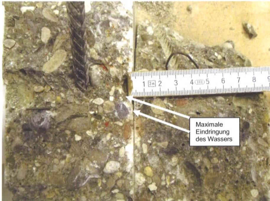
Bild 3: Probe 1 nach dem Aufspalten zur Messung der Wassereindringtiefe 3 mm
