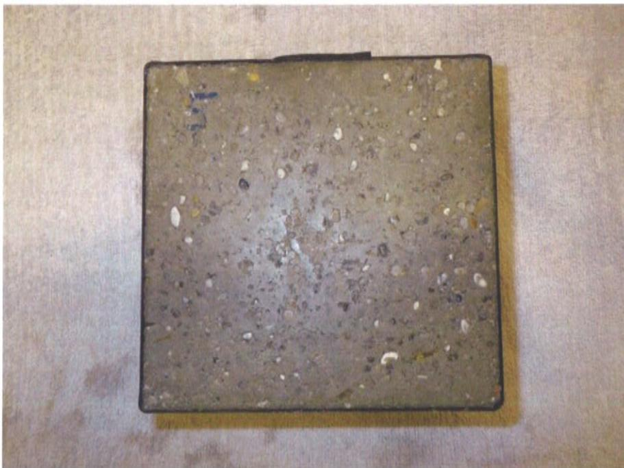
Bild 7: Probe 5 nach 28 Frost-Tau-Wechsel, abgewitterte Oberfläche. keine Ablösungen am Abstandshalter erkennbar.
