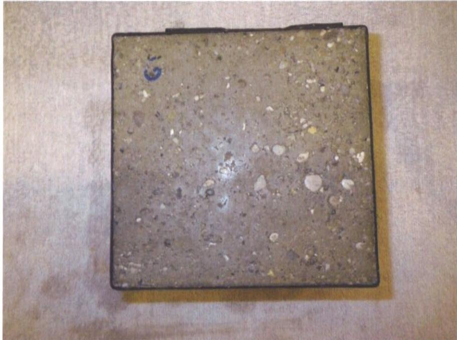
Bild 8: Probe 6 nach 28 Frost-Tau-Wechsel, abgewitterte Oberfläche.
