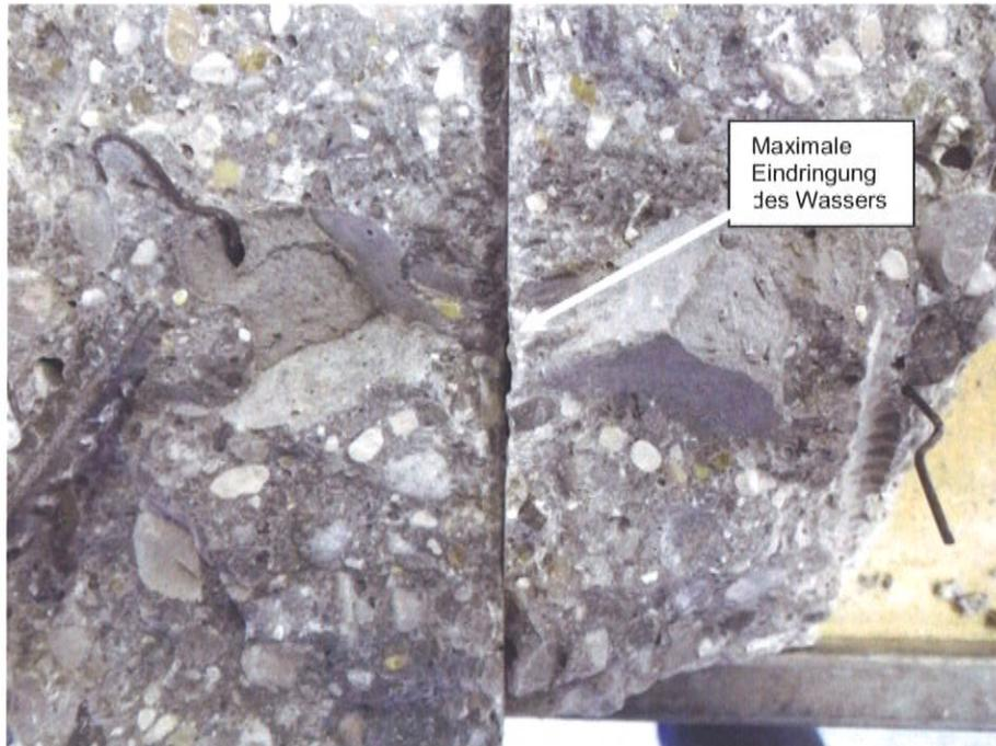
Bild 5: Probe 3 nach dem Aufspalten zur Messung der Wassereindringtiefe 1 mm
