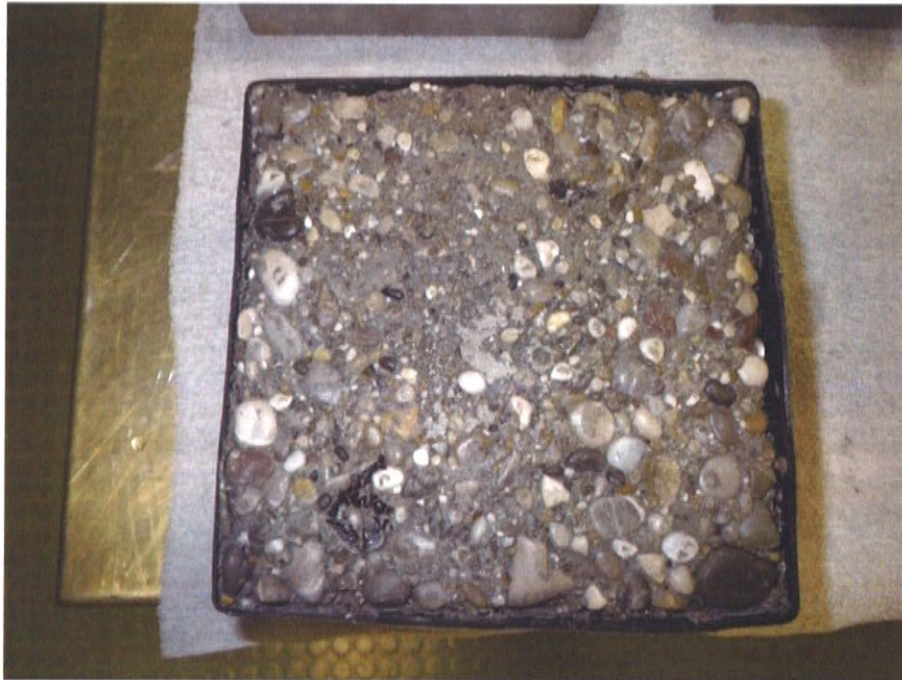
Bild 8: Probe 6 nach 28 Frost-Tau-Wechsel, stark abgewitterte Oberfläche. Keine Schäden am Abstandshalter erkennbar.
