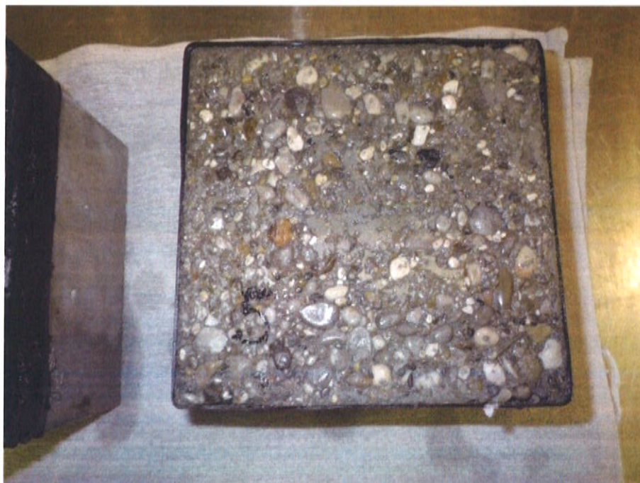
Bild 7: Probe 5 nach 28 Frost-Tau-Wechsel, stark abgewitterte Oberfläche. Keine Schäden am Abstandshalter erkennbar.
