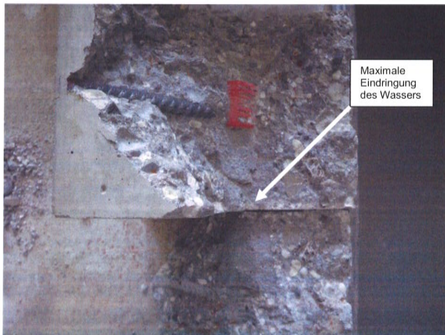
Bild 4: Probe 2 nach dem Aufspalten zur Messung der Wassereindringtiefe 2 mm
