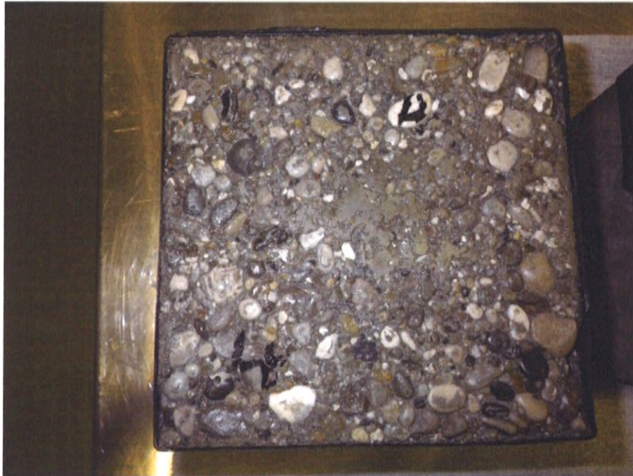
Bild 6: Probe 4 nach 28 Frost-Tau-Wechsel, stark abgewitterte Oberfläche. Keine Schäden am Abstandshalter erkennbar.
