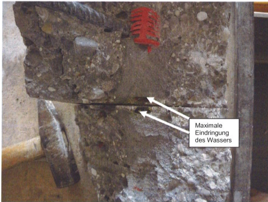
Bild 3: Probe 1 nach dem Aufspalten zur Messung der Wassereindringtiefe 5 mm
