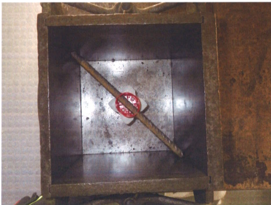
Bild 2: Würfelschalung mit eingebautem Abstandshalter
